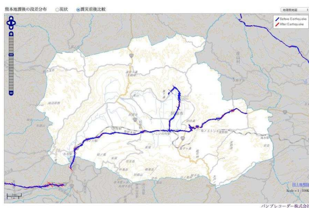
図11 阿蘇市の路面性状の地震前後比較
